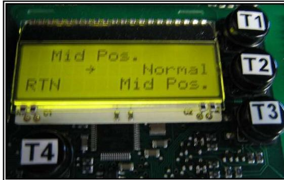
Selektieren Sie Mitt Pos. Dann T4 drücken um zurückzugehen nach dem Auswahlmenü. Wählen Sie MENÜ → POSITIONEN und verlegen Sie die Abdeckung nach der gewünschten Position (T1/T3)
