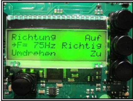
Kontrollier mit den Tasten T1 und T3 ob die Drehrichtung der Asche übereinstimmt mit den Daten auf der Anzeige und ändern Sie wenn nötig mit T4. Falls die Drehrichtung korrekt ist, sollen Sie die Asche mindestens 5 Sekunden drehen lassen sodass die Steuerung detektieren kann ob 1 oder 2 Kanäle der Encoders angeschlossen sind. Bestätigen mit T2.
