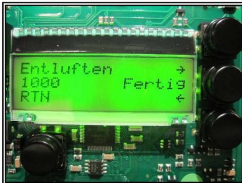
**ANMERKUNG:** Bei einem hydraulischen Motor gibt es einen zusätzlichen Schritt um die Luft aus den Schläuchen zu entfernen. Dafür sollen Sie den Motor in eine Drehrichtung laufen lassen bis der Zähler auf 0 steht.
