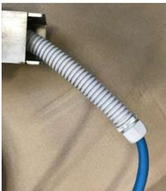
**Entfernen Sie vor dem Einbau der Welle den grauen Kabelschutz. Stellen Sie sicher, dass das Kabel während dieses Vorgangs nicht vom Edelstahl beschädigt wird.**
